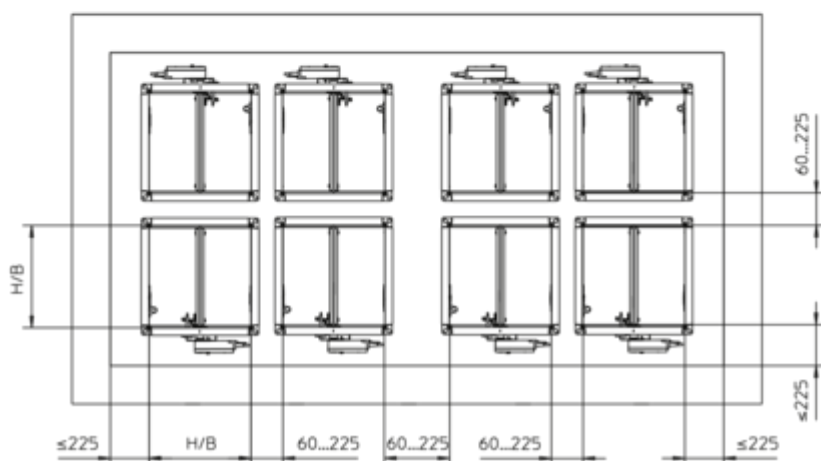
Bild 102: Murbruksbaserad installation – flera enheter i en installationsöppning i korsvirkeskonstruktion
